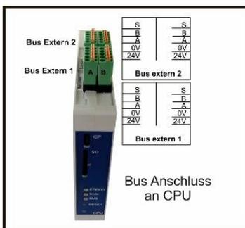
Jede CPS-Anlage hat im Standard 2 Bus-Abgänge „Bus extern 1“ und „Bus extern 2“.
